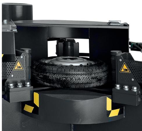
Die Maschine ist mit einem leistungsstarken Hydraulikaggregat und 3 Zylindern ausgestattet. Dadurch wird eine Verformung der Felge erzielt, so dass diese in einem Handgriff vom Reifen getrennt werden kann.
